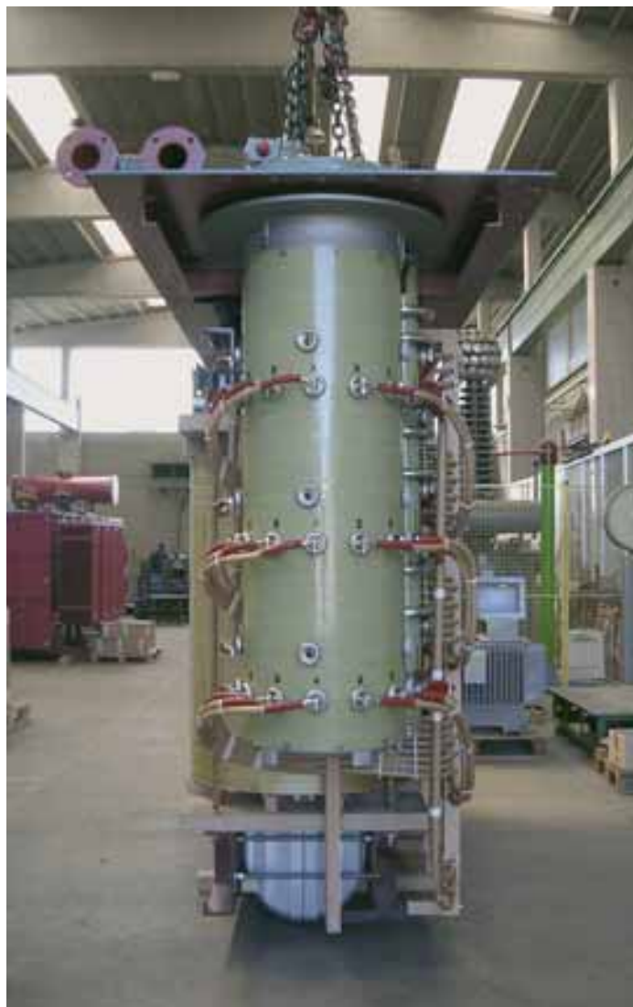
16 MVA KV 33 ± 9x1,25% PARTE ESTRAIBILE - ACTIVE PART
